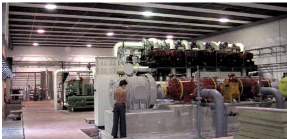
Hall des pompes des souffleries. Laboratoire ICARE, CNR (photo CNRS)
